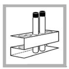
12. 将预制管放在 试管架上冷却至室 温。
